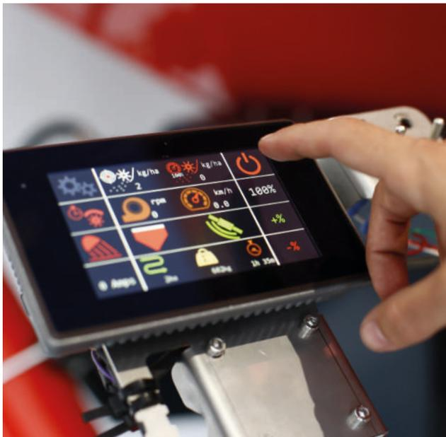
La tolva frontal **TF AIR** está disponible con una pantalla propia para tractores no ISOBUS así como con comunicación ISOBUS para poder ser visualizada en la pantalla de cualquier tractor ISOBUS.
